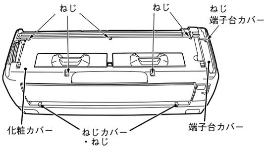
②端子台カバーのねじをゆるめ、端子台カバーをはずします。
