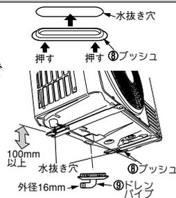
寒冷地等で寒さが厳しく積雪等が多いと、熱交換器から出る水がベース表面に凍結し、排水が悪くなる場合があります。このような地域では、プッシュ、ドレンパイプは取り付けないでください。水抜き穴と地面との距離を250mm以上確保してください。
