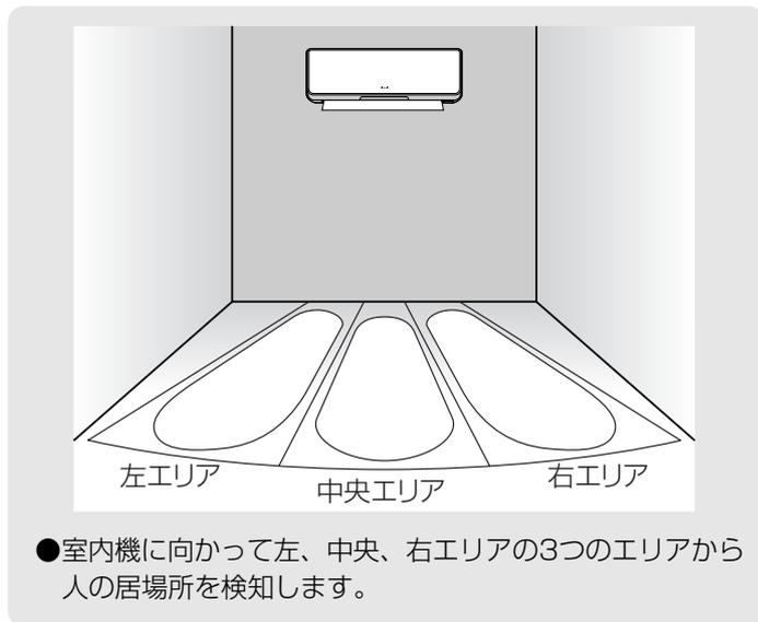
「エコ運転」機能と「センサー風あて」／「センサー風よけ」機能の制御を行います。
