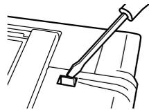
④化粧カバー右部上の穴にドライバー等を差し込み、爪を外します。
