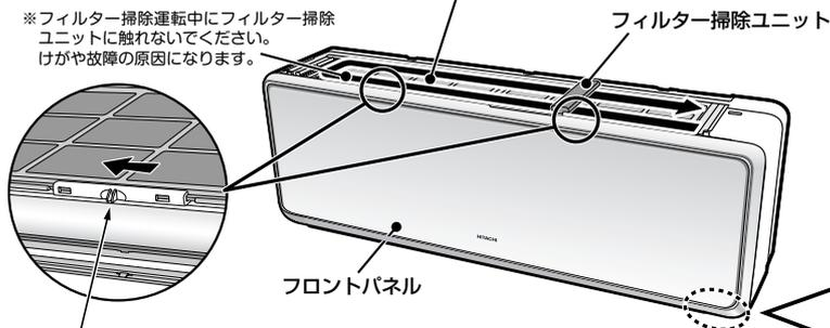
※フィルターが確実に取付けられて、フィルターロックがロック側(左端)に固定されていることを確認してください。
