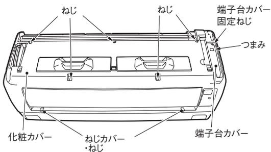
②端子台カバー固定ねじをゆるめ、つまみを持って端子台カバーをはずします。
