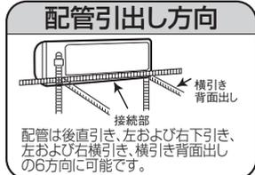
横引きなど室内を通す配管は、保冷用断熱材をかぶせてください。(保冷用断熱材が不足するときはサービスパーツ品 RAS-LJ22W 006(別売)を使用してください。)
