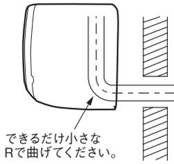
冷媒配管の曲げ始めが壁穴範囲から出ていたり、曲げRが大きいと、室内機が壁から浮き上がり、仕上がりが悪くなる原因となります。
