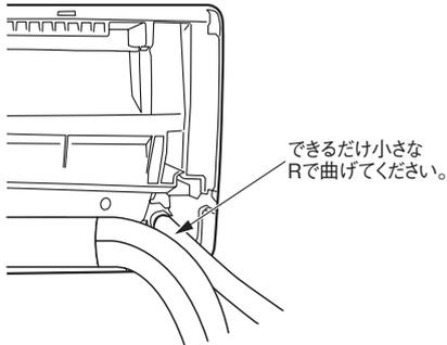
冷媒配管の曲げ始めが壁穴範囲から出ていたり、曲げRが大きいと、室内機が壁から浮き上がり、仕上がりが悪くなる原因となります。
