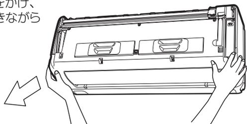
④化粧カバー右部上の穴にドライバー等を差し込み、爪を外します。
