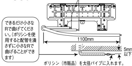
できるだけ小さなRで曲げてください。(ポリシンを使用すると配管を潰さずに小さなRで曲げることができます)
