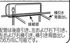
配管は後直引き、左および右引き、左および右横引き、横引き背面出しの6方向が可能です。
