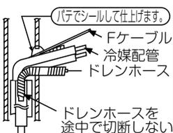
室内機のドレンホースは、室外機のバルブカバーへ導かないでください。使用条件により、バルブカバーより水垂れの恐れがあります。
