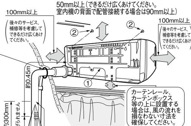
カーテンレール、カーテンボックス等の上に設置する場合は、風の流れを損なわない寸法を確保してください。
