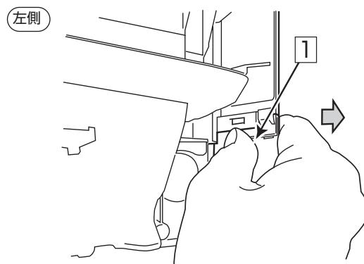
下カバーは①部を矢印方向に押し取り外します。
