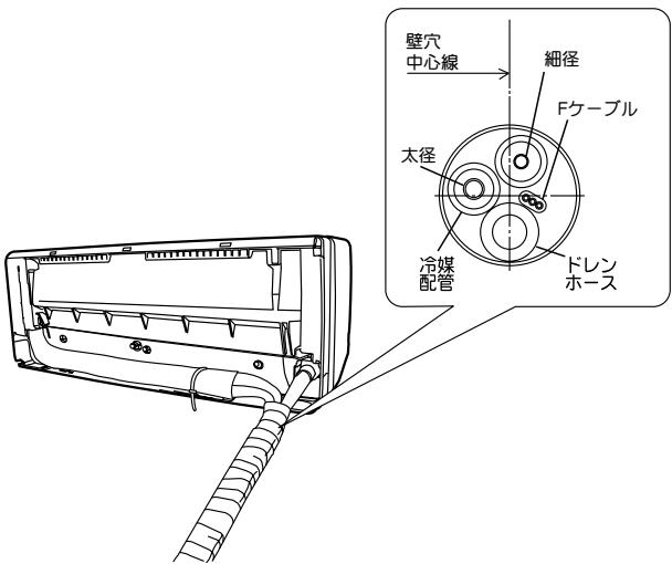
④Fケーブル、配管を整形し、室内機背面の下部スペースに納め、結束バンド(市販品)を背面フックに引っ掛け固定します。
