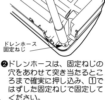
②ドレンホースは、固定ねじの穴をあわせて突き当たるところまで確実に押し込み、①ではずした固定ねじで固定してください。
