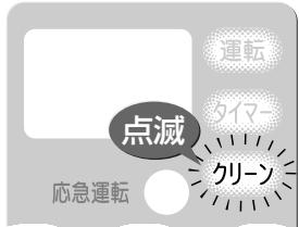
●フィルター掃除運転の動作確認は、1往復で約5分間行います。フィルター掃除ユニットが実際に動作しているかの確認は、室内機上面から目視にて確認してください。
