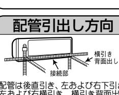
横引きなど室内を通す配管は、保冷用断熱材をかぶせてください。
