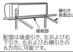
配管は後直引き、左および右下引き、左および右横引きの6方向に可能です。
