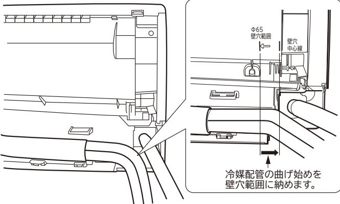
冷媒配管の曲げ始めが壁穴範囲から出でていたり、曲げRが大きいと、室内機が壁から浮き上がり、仕上りが悪くなる原因となります。
