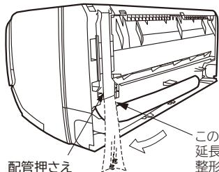
この部分の冷媒配管の延長線上に伸ばしてから整形します。
