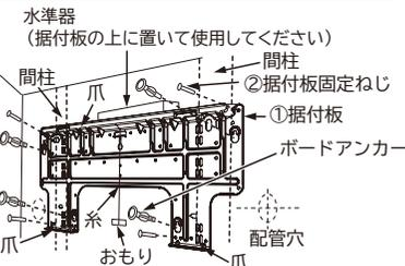
ねじ止めは、できるだけ室内機の爪をひっかけ上下の爪の付近で行ってください。また、4本以上のねじで固定してください。
