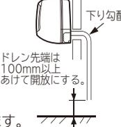
●浄化槽等、腐食性ガス(硫黄・アンモニア等)が発生する場所にドレンホースを導かない
