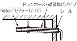
●埋込配管などでドレンホースをドレン配管に挿入する場合、ドレンホースを途中で切断しない
