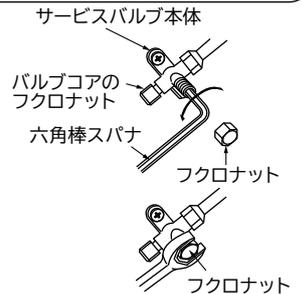
フクロナットは手締めでは冷媒漏れを防げません。スパナを使用してしっかり締め付けてください。
