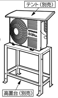
●転倒・落下・設置位置のずれがないように室外機を固定してください。
