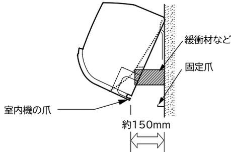
※室内機の下部を手前に浮かして、室内機の背面で冷媒配管を接続する作業が難しい場合があります。この場合は、当据付説明書のP.15に記載しています「フロントパネル・化粧カバーの着脱のしかた」を参照し、化粧カバーを取り外して配管の接続を実施してみてください。
