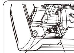
②ドレンキャップの穴に六角棒スパナを挿入して、ドレンキャップを押して、突き当たるところまで確実に挿入してください。
