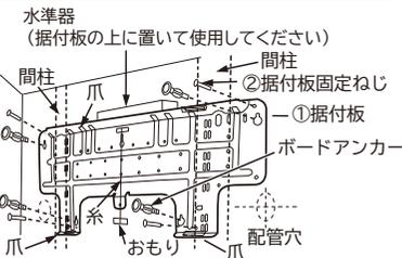
ねじ止めは、できるだけ室内機の爪をひっかけると、上下の爪の付近で行ってください。また、4本以上のねじで固定してください。
