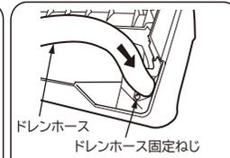
②ドレンホースは、固定ねじの穴をあわせて突き当たるところまで確実に押し込み、②で外した固定ねじで固定してください。
