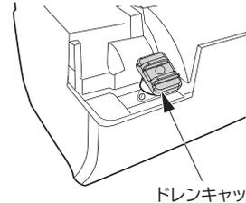
ドレン口先端に当たるまで押し込む必ず目視で確認してください。
