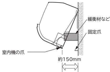
④冷媒配管を接続します（P.10の「配管の接続・エアパージ」を参照）。
