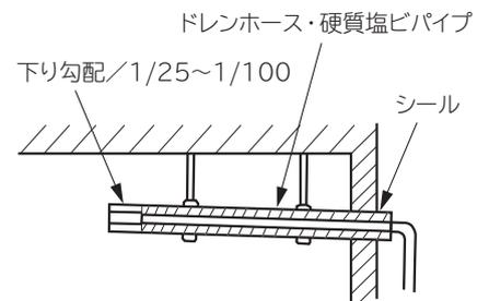
気密性の高い住宅等で強風時や換気扇を使用したときなどに、ドレン水がスムーズに流れず、異音(ポコポコ音等)が発生したり、水漏れが発生することがあります。
