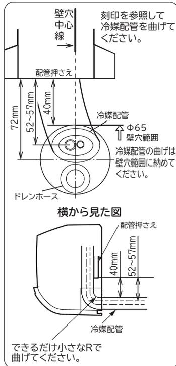
冷媒配管の曲げ始めが壁穴範囲から出ている、曲げRが大きいと、室内機が壁から浮き上がり、仕上がりが悪くなる原因となります。
