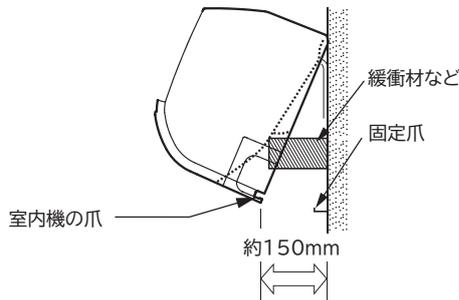
※室内機の下部を手前に浮かして、室内機の背面で冷媒配管を接続する作業が難しい場合があります。この場合は、当据付説明書P.15に記載しています「フロントパネル・化粧カバーの着脱のしかた」を参照し、化粧カバーを取り外して配管の接続を実施してみてください。
