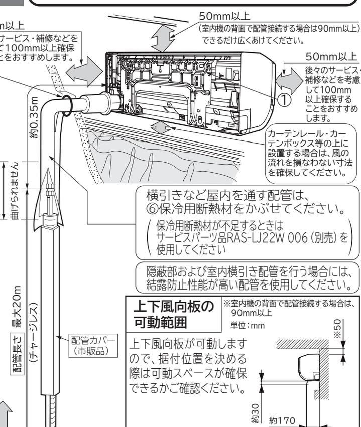
横引きなど室内を通す配管は、⑥保冷用断熱材をかぶせてください。
