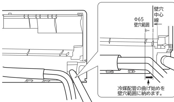
冷媒配管の曲げ始めが壁穴範囲から出ていると、曲げRが大きいと、室内機が壁から浮き上がり、仕上がりが悪くなる原因となります。
