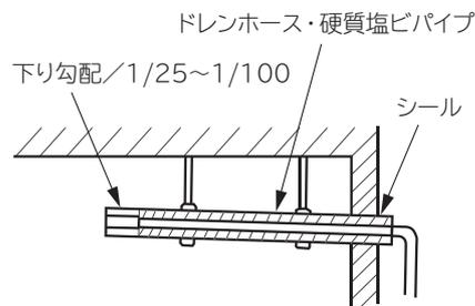
気密性の高い住宅などで強風時や換気扇を使用したときなどに、ドレン水がスムーズに流れず、異音(ポコポコ音等)が発生したり、水漏れが発生することがあります。
