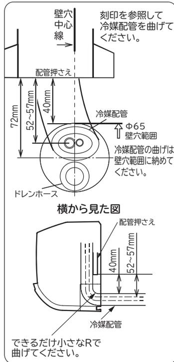
冷媒配管の曲げ始めが壁穴範囲から出ていたり、曲げRが大きいと、室内機が壁から浮き上がり、仕上りが悪くなる原因となります。
