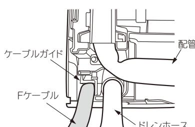
④ ケーブル固定ねじを外し、ケーブル固定バンドを外してFケーブルを接続し、ケーブル固定バンドで固定します。
