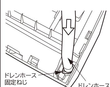
②ドレンホースは、固定ねじの穴をあわせて突き当たるところまで確実に押し込み、①で外した固定ねじで固定してください。
