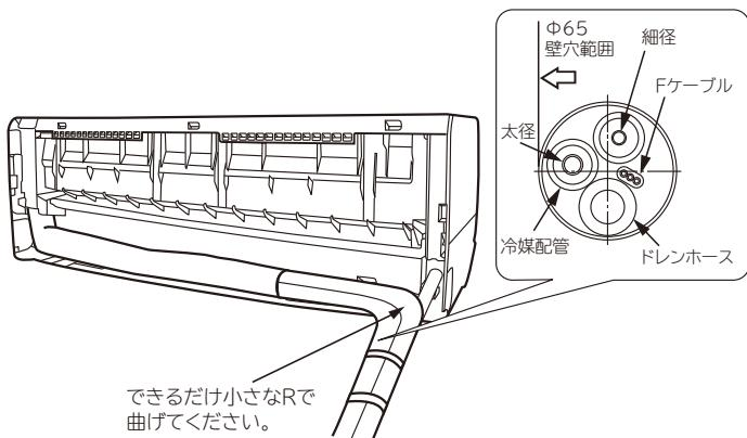
④ Fケーブル・配管を整形し、室内機背面の下部スペースに納め、結束バンド(市販品)を背面フックに引っ掛け固定します。
