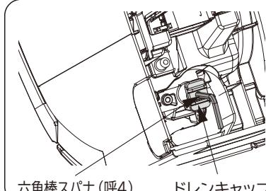
②ドレンキャップの穴に六角棒スパナもしくは細いドライバーを挿入して、ドレンキャップを押して、突き当たるところまで確実に挿入してください。
