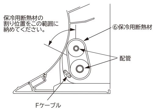
③ 冷媒配管を壁穴位置に合わせて整形します。
