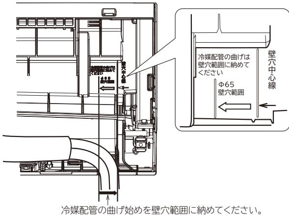
冷媒配管の曲げ始めを壁穴範囲に納めてください。
