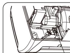
②ドレンキャップの穴に六角棒スパナを挿入して、ドレンキャップを押して、突き当たるところまで確実に挿入してください。
