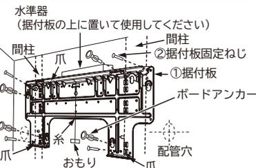
ねじ止めは、できるだけ室内機の爪をひっかけると、上下の爪の付近で行ってください。また、4本以上のねじで固定してください。
