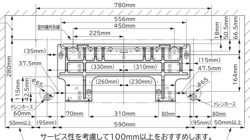
「たてさん」を使用して、室内機の背面で冷媒配管を接続する場合は、下の図のように施行してください。
