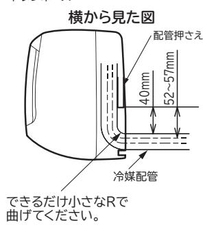
冷媒配管の曲げ始めが壁穴範囲から出でていたり、曲げRが大きいと、室内機が壁から浮き上がり、仕上りが悪くなる原因となります。
