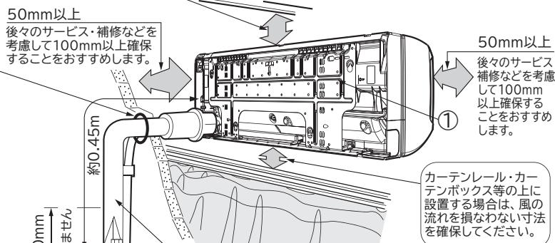
横引きなど屋内を通す配管は、⑦保冷用断熱材をかぶせてください。
