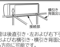
配管は後直引き・左および右下引き・左および右横引き・横引き背面出しの6方向に可能です。
