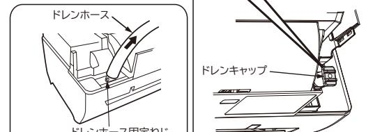
ドレンキャップは固定ねじを外して、抜きます。
