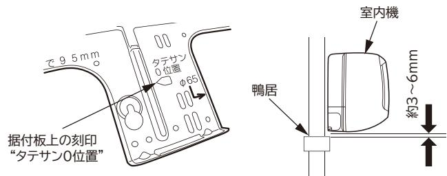
「たてさん」を使用して、室内機の背面で冷媒配管を接続する場合は、下の図のように施行してください。
