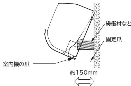
④冷媒配管を接続します(P.10の「配管の接続・エアページ」を参照)。
