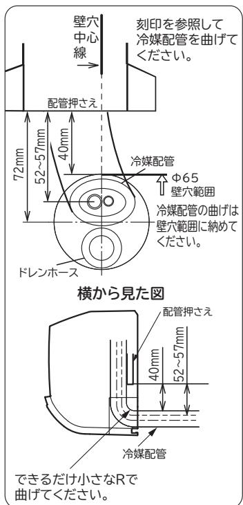
冷媒配管の曲げ始めが壁穴範囲から出でていたり、曲げRが大きいと、室内機が壁から浮き上がり、仕上りが悪くなる原因となります。
