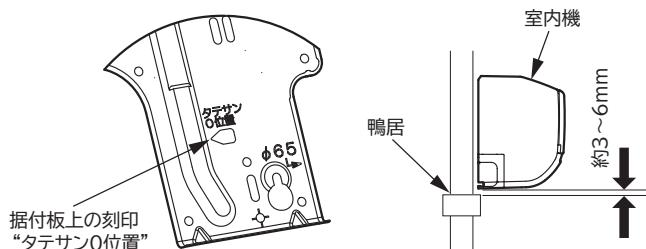
「たてさん」を使用して、室内機の背面で冷媒配管を接続する場合は、下の図のように実行してください。
