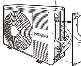
冷媒配管とケーブルの接続は、側面カバーを外して行います。
