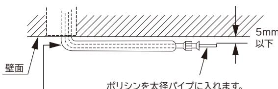
できるだけ小さなRで曲げてください。(ポリシンを使用すると配管を潰さずに小さなRで曲げることができます。)
