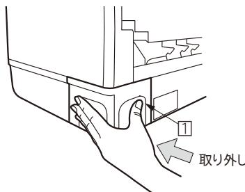
● 取り付けは②部を先に取り付け、①部を支点として回転させて①部を取り付けます。
