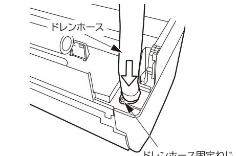
② ドレンホースは、固定ねじの穴をあわせて突き当たるところまで確実に押し込み、①で外した固定ねじで固定してください。
