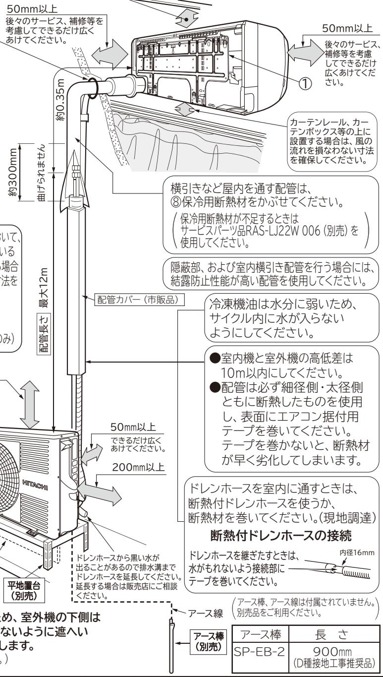
カーテンレール、カーテンボックス等の上に設置する場合は、風の流れを損なわない寸法を確保してください。
