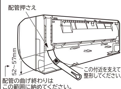
冷媒配管の曲げ始めが壁穴範囲から出でていたり、曲げRが大きいと、室内機が壁から浮き上がり、仕上りが悪くなる原因となります。
