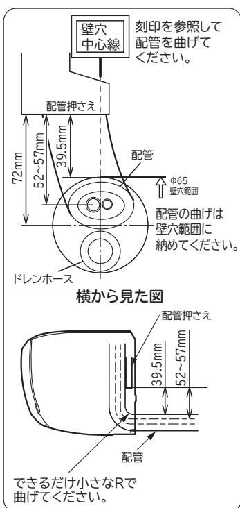
配管の曲げ始めが壁穴範囲から出でていたり、曲げRが大きいと、室内機が壁から浮き上がり、仕上りが悪くなる原因となります。
