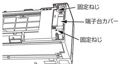
フロントパネルを閉めるときは、フロントパネルの左右2カ所を先に、その後に中央部2カ所を「カチッ」という音がするまで押し付けてください。
