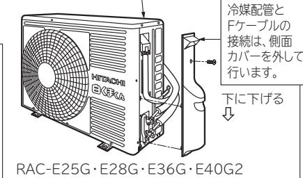
冷媒配管とFケーブルの接続は、側面カバーを外して行ってください。
