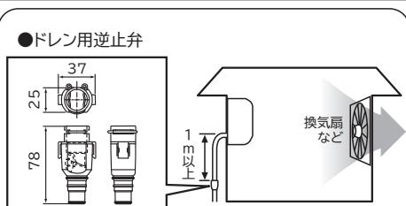
気密性の高い住宅などで強風時や換気扇を使用したときなどに、ドレン水がスムーズに流れず、異音(ボコボコ音など)が発生したり、水漏れが発生することがあります。対応部品(斡旋品)として因幡電機産業(株)製ドレン用逆止弁「DHB-1416 701」(有料)がありますので必要に応じて取り付けてください。製品に関するご相談は販売店にお問い合わせください。
