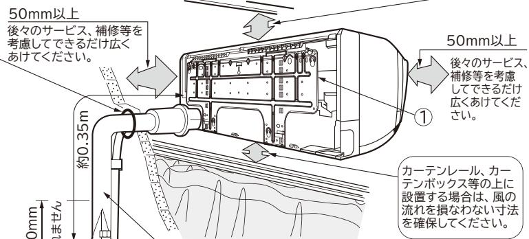
カーテンレール、カーテンボックス等の上に設置する場合は、風の流れを損なわない寸法を確保してください。
