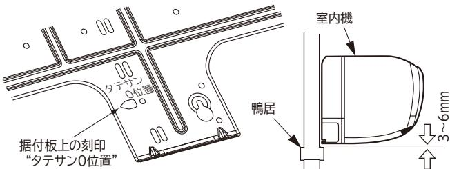
「たてさん」を使用して、室内機の背面で冷媒配管を接続する場合は、下図のように実行してください。
