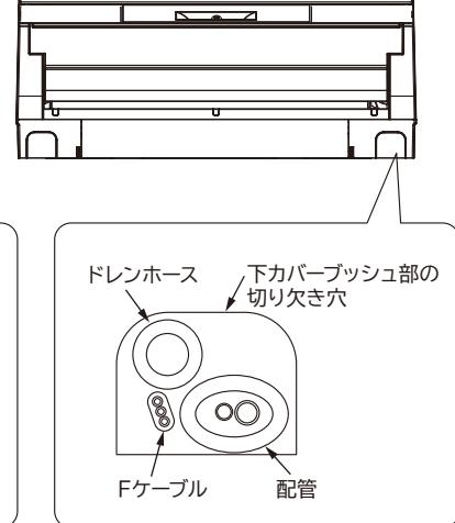
④壁穴貫通部をエアコン据付用テープでテープ巻きします。
