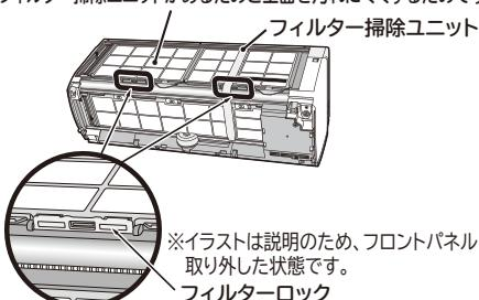
●フィルター掃除ユニット動作中は、可動パネル・上下風向板が閉じたまま送風運転を行い、「クリーン」ランプが点灯します。
