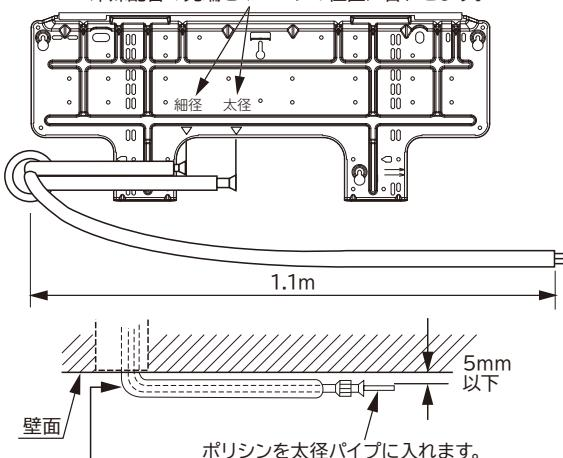
できるだけ小さなRで曲げてください(ポリシンを使用すると配管を潰さずに小さなRで曲げることができます)。
