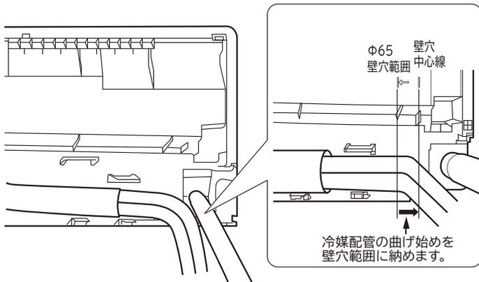
冷媒配管の曲げ始めが壁穴範囲から出ていたり、曲げRが大きいと、室内機が壁から浮き上がり、仕上りが悪くなる原因となります。
