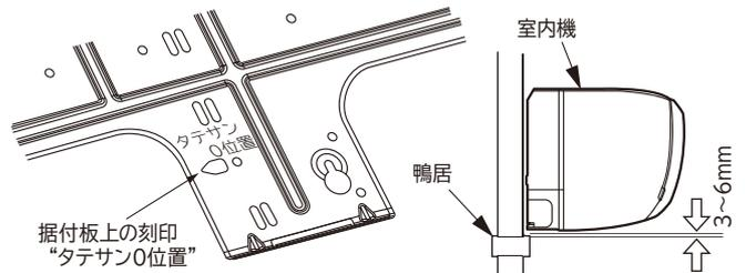
「たてさん」を使用して、室内機の背面で冷媒配管を接続する場合は、下図のように施行してください。
