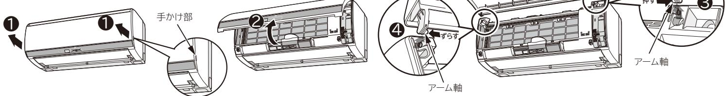
①手かけ部に手をかけ、フロントパネルを矢印方向に引き、開けます。
