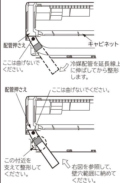
冷媒配管の曲げ始めが壁穴範囲から出でていたり、曲げRが大きいと、室内機が壁から浮き上がり、仕上りが悪くなる原因となります。
