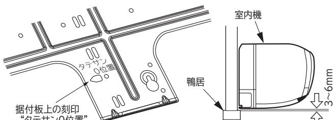
「たてさん」を使用して、室内機の背面で冷媒配管を接続する場合は、右図のように実行してください。
