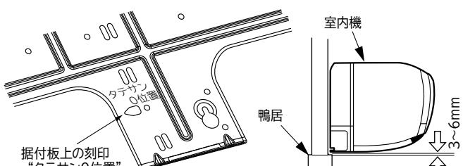
「たてさん」を使用して、室内機の背面で冷媒配管を接続する場合は、右図のように実行してください。
