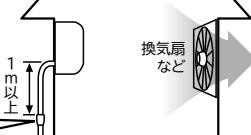
気密性の高い住宅などで強風時や換気扇を使用したときなどに、ドレン水がスムーズに流れず、異音(ポコポコ音など)が発生したり、水漏れが発生することがあります。対応部品(斡旋品)として因幡電機産業(株)製ドレン用逆止弁「DHB-1416 701」(有料)がありますので必要に応じて取り付けてください。製品に関するご相談は販売店にお問い合わせください。
