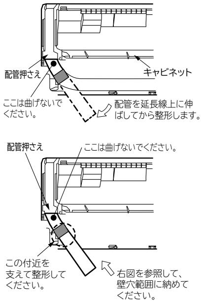
配管の曲げ始めが壁穴範囲から出でていたり、曲げRが大きいと、室内機が壁から浮き上がり、仕上がりが悪くなる原因となります。
