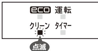
●「フィルター掃除」運転の動作は、**1往復で約9分間**行います。フィルター掃除ユニットが実際に動作しているかの確認は、室内機上面から目視にて確認してください。
