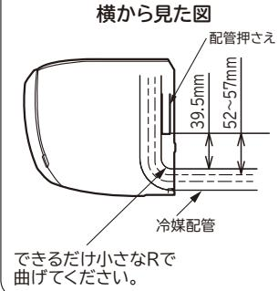
冷媒配管の曲げ始めが壁穴範囲から出でていたり、曲げRが大きいと、室内機が壁から浮き上がり、仕上りが悪くなる原因となります。
