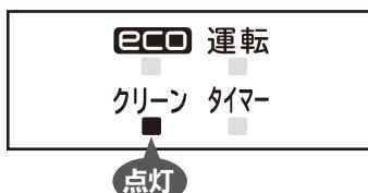
●動作確認運転後に「クリーン」ランプが点滅（4秒点灯／1秒消灯）表示したときは「フィルター掃除」運転の異常による停止です。フロントパネルを開け、輸送用部品が貼り付いたままになっていることを確認してください。輸送用部品が貼り付いていない場合は、取扱説明書の「フィルター掃除運転の動作確認」「お困りのときは」のページを参照の上、対応をお願いします。
