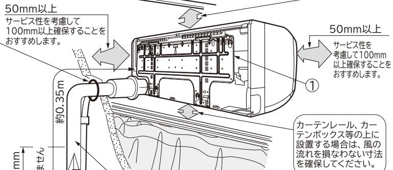
カーテンレール、カーテンボックス等の上に設置する場合は、風の流れを損なわない寸法を確保してください。
