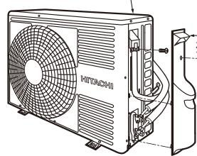
冷媒配管とケーブルの接続は、側面カバーを外して行います。
