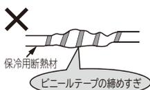
断熱効果がなくなり露が付き露たれおよび壁にシミやカビが発生します。
