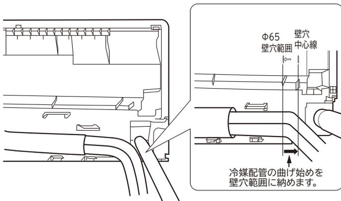
冷媒配管の曲げ始めが壁穴範囲から出ている、曲げRが大きいと、室内機が壁から浮き上がり、仕上がりが悪くなる原因となります。
