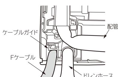
④ ケーブル固定ねじをゆるめケーブル固定バンドを外してFケーブルを接続し、ケーブル固定バンドで固定します。
