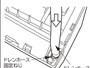
② ドレンホースは、固定ねじの穴をあわせて突き当たるところまで確実に押し込み、①で外した固定ねじで固定してください。
