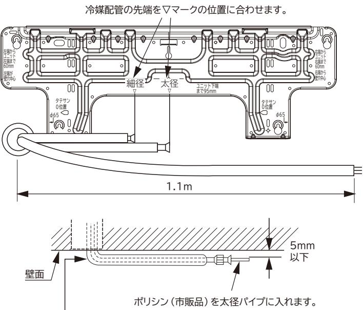
できるだけ小さなRで曲げてください。(ポリシンを使用すると配管を潰さずに小さなRで曲げることができます。)
