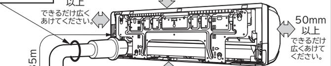
カーテンレール・カーテンボックスなどの上に設置する場合は、障害物の寸法が110mm以内であれば、下記寸法で設置できます。また、点検・修理のためエアコンのまわりはなるべく距離を明け、風の流れを損なわない寸法を確保してください。
