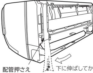
配管押さえ 下に伸ばしてから整形します。
