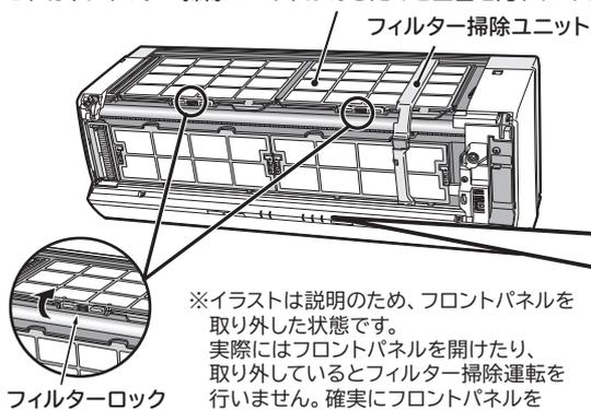
※イラストは説明のため、フロントパネルを取り外した状態です。実際にはフロントパネルを開けたり、取り外しているとはフィルター掃除運転を行いません。確実にフロントパネルを閉じてください。
