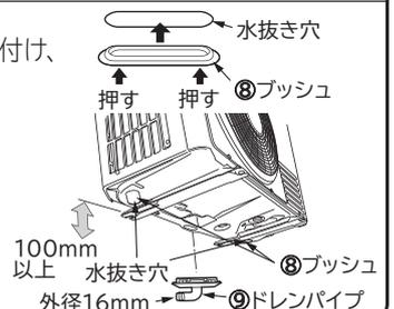
寒冷地等で寒さが厳しく積雪等が多いと、熱交換器から出る水がベース表面に凍結し、排水が悪くなる場合があります。このような地域では、プッシュ・ドレンパイプは取り付けないでください。
