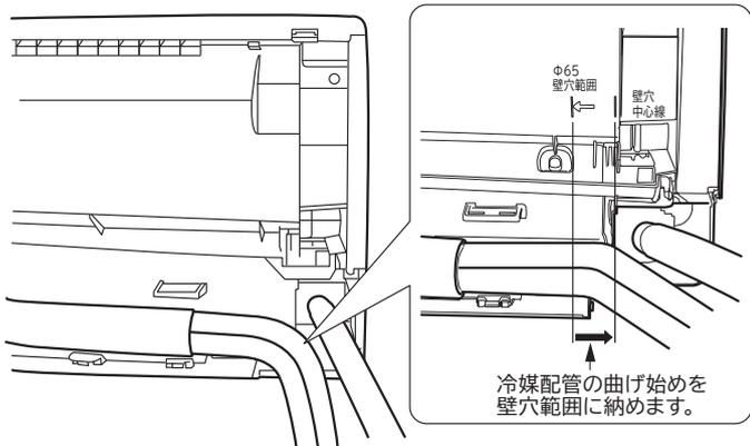
冷媒配管の曲げ始めが壁穴範囲から出ていたり、曲げR
