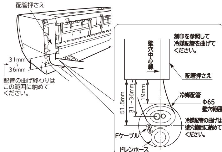
冷媒配管の曲げ始めが壁穴範囲から出でていたり、曲げRが大きいと、室内機が壁から浮き上がり、仕上りが悪くなる原因となります。
