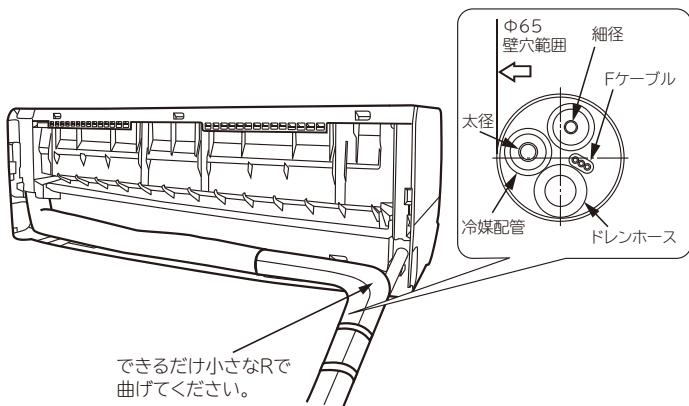
⑤ Fケーブル・配管を整形し、室内機背面の下部スペースに納め、結束バンド(市販品)を背面フックに引っ掛け固定します。
