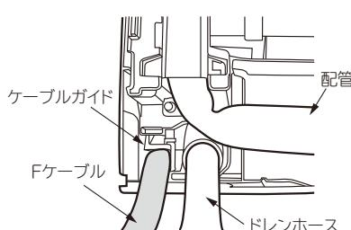
④ケーブル固定ねじをゆるめケーブル固定バンドを外して
