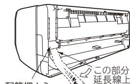
この部分の冷媒配管の延長線上に伸ばしてから整形します。
