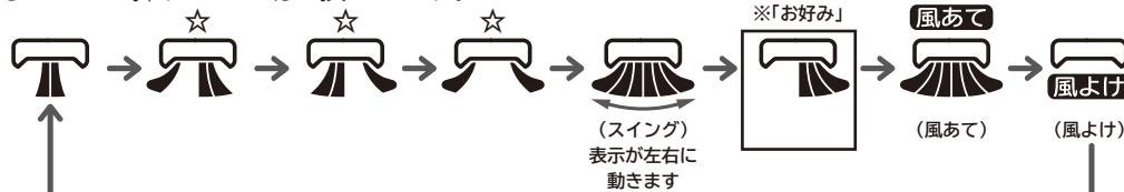
スイング中に 左右風向 を押すと、リモコンの左右風向板表示が停止し、風向板がリモコン表示の位置になります。お好みの位置で停止してください。
