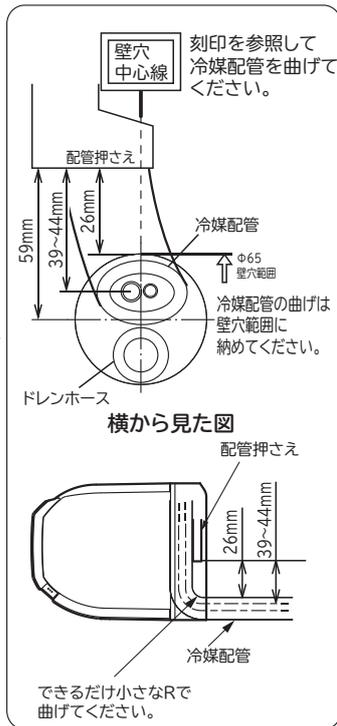
冷媒配管の曲げ始めが壁穴範囲から出ていると、曲げRが大きいと、室内機が壁から浮き上がり、仕上がりが悪くなる原因となります。
