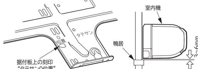
「たてさん」を使用して、室内機の背面で冷媒配管を接続する場合は、下の図のように施行してください。
