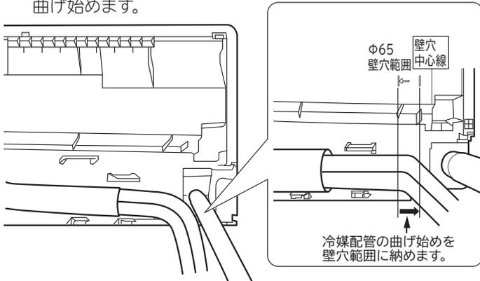
冷媒配管の曲げ始めが壁穴範囲から出ていたり、曲げが大きいと、室内機が壁から浮き上がり、仕上りが悪くなる原因となります。
