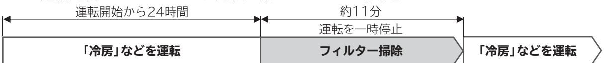
24時間過ぎるごとに運転を一時停止して、フィルターを掃除します。(室内機内部の乾燥はしません →P.33)
