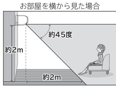
※温度カメラは天井の温度も検知します。
