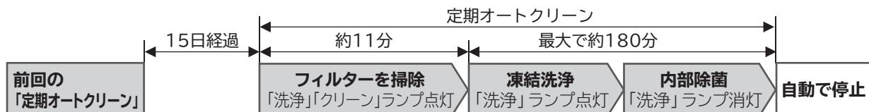
※「定期オートクリーン」を設定して「冷房」などの運転をしていない場合は、15日経過するごとにフィルターを掃除したあと、「凍結洗浄」をします。また、15日経過する前に「冷房」などを運転した場合は、エアコンを運転していない時間の合計が15日間経過するとフィルターを掃除したあと、「凍結洗浄」をします。15日経過する前に「凍結洗浄」をした場合は、「凍結洗浄」をしてから15日後に「定期オートクリーン」をします。
