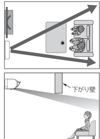
「気流の通り道」を見つける動作では、下がり壁やキッチンの吊り戸棚を検知し、避けて気流を通します。
