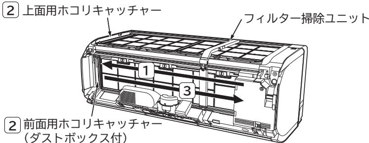
説明のため、フロントパネルを取り外しています。けがや故障の原因になりますので、フロントパネルを取り外したり開けたままで、フィルターの掃除をしないでください。
