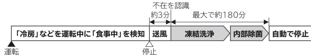
自動でフィルターを掃除する条件になっていたときは、フィルターを掃除してから「凍結洗浄」をします。
