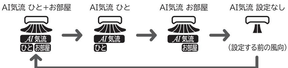
設定および設定の変更・取り消しは記憶されます。また、風向を調整して取り消された場合もその状態が記憶されます。必要に応じて再度設定してください。
