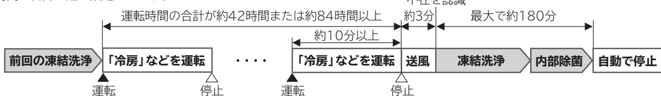
「凍結洗浄」を開始するまでの運転時間の合計は、「くらしカメラAI」で検知したつぎのお部屋のタイプによって異なります
