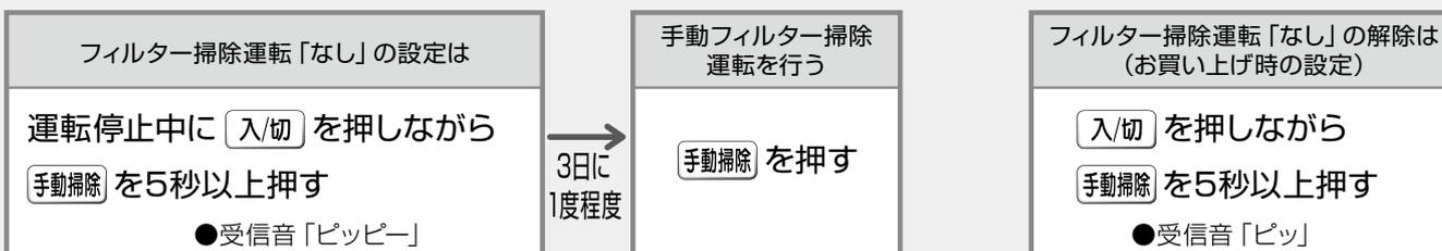
※フィルター掃除運転「なし」の設定で、手動フィルター掃除運転を実施中に停電があった場合は、フィルター掃除ユニットが途中で止まる場合があります。その場合は、再度手動フィルター掃除運転を行ってください。
