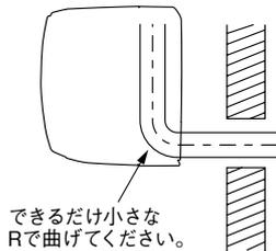
冷媒配管の曲げ始めが壁穴範囲から出ていると、曲げRが大きいと、室内機が壁から浮き上がり、仕上りが悪くなる原因となります。
