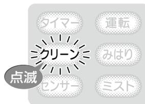
●フィルター掃除運転の動作確認は、**1往復で約6分間**行います。フィルター掃除ユニットが実際に動作しているかの確認は、室内機上面から目視にて確認してください。
