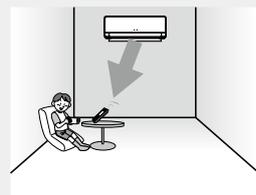
●室内機に向かって左・中央・右エリアと、室内機から見て遠距離～近距離エリアの9つのエリアからリモコンの場所を検知します。
