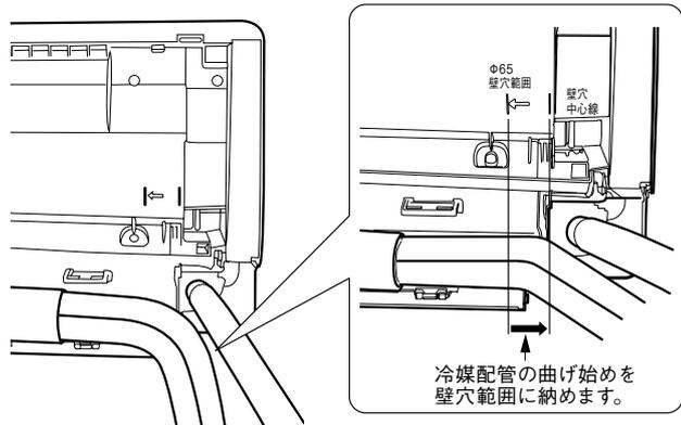
冷媒配管の曲げ始めが壁穴範囲から出ていたり、曲げRが大きいと、室内機が壁から浮き上がり、仕上がりが悪くなる原因となります。
