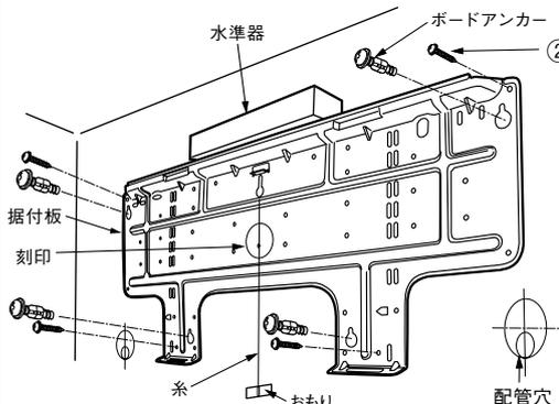
ねじ止めは、できるだけ室内機をひっかける上下の爪の付近で行ってください。また、4本以上のねじで固定してください。
