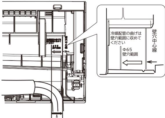
冷媒配管の曲げ始めを壁穴範囲に納めます。
