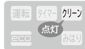
●動作確認運転後に「クリーン」ランプが点滅（4秒点灯／1秒消灯）表示したときは「フィルター掃除運転」の異常による停止です。フロントパネルを開け、輸送用部品が貼り付いたままになっていないことを確認してください。輸送用部品が貼り付いていない場合は、取扱説明書の「フィルター掃除運転の動作確認」「故障かな?と思われるときは」のページを参照の上、対応をお願いします。
