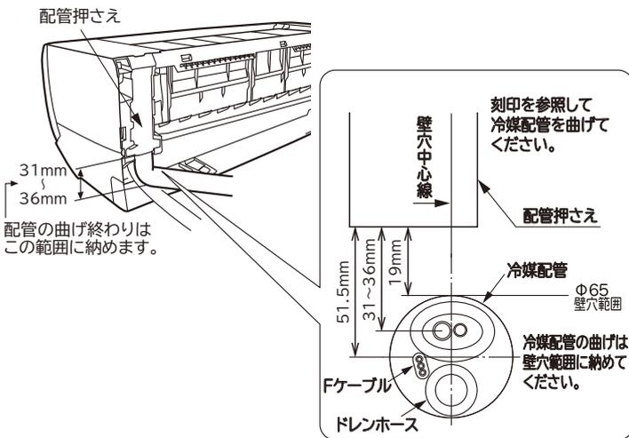
冷媒配管の曲げ始めが壁穴範囲から出ていたり、曲げRが大きいと、室内機が壁から浮き上がり、仕上がりが悪くなる原因となります。
