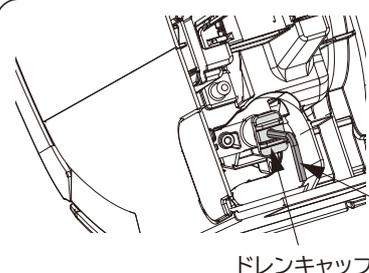
②ドレンキャップの穴に六角棒スパナを挿入して、ドレンキャップを押し、突き当たるところまで確実に挿入してください。
