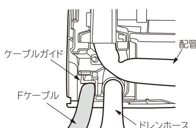
④ ケーブル固定ねじをゆるめケーブル固定バンドを外してFケーブルを接続し、ケーブル固定バンドで固定します。
