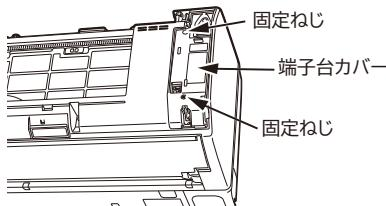
フロントパネルを閉めるときは、フロントパネルの左右2カ所を先に、その後に中央部2カ所を「カチッ」という音がするまで押し付けてください。
