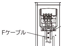
Fケーブルの被覆部が必ず端子台カバーで押さえられるように接続してください。
