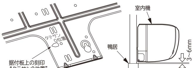
「たてさん」を使用して、室内機の背面で冷媒配管を接続する場合は、右図のように施行してください。
