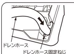
②ドレンホースは、固定ねじの穴をあわせて突き当たるところまで確実に押し込み、②で外した固定ねじで固定してください。
