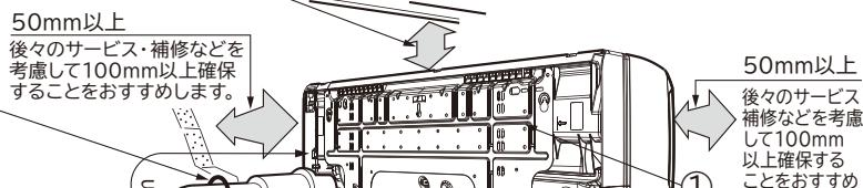
カーテンレール・カーテンボックス等の上に設置する場合は、風の流れを損なわない寸法を確保してください。
