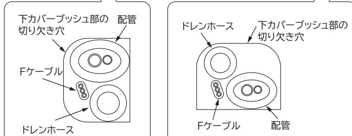
冷媒配管の曲げ始めが壁穴範囲から出ていると、曲げRが大きいと、室内機が壁から浮き上がり、仕上りが悪くなる原因となります。
