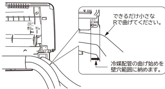
冷媒配管の曲げ始めが壁穴範囲から出ていたり、曲げRが大きいと、室内機が壁から浮き上がり、仕上がりが悪くなる原因となります。
