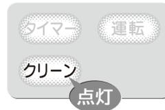
●動作確認運転後に「クリーン」ランプが点滅（4秒点灯／1秒消灯）表示したときは「フィルター掃除運転」が何らかの異常により、途中で停止したということです。フロントパネルを開け、輸送用部品が貼り付いたままになっていないことを確認してください。輸送用部品が貼り付いていない場合は、取扱説明書の「フィルター掃除運転の動作確認をする」「故障かな?と思われるときは」のページを参照の上、対応をお願いします。
