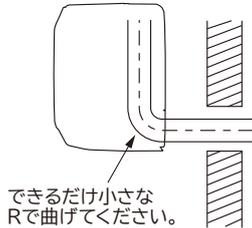
冷媒配管の曲げ始めが壁穴範囲から出ていたり、曲げRが大きいと、室内機が壁から浮き上がり、仕上がりが悪くなる原因となります。
