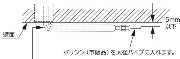
できるだけ小さなRで曲げてください。(ポリシンを使用すると配管を潰さずに小さなRで曲げることができます)
