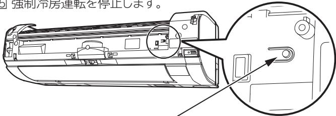
（5秒以上押し続けると強制冷房運転を開始します
