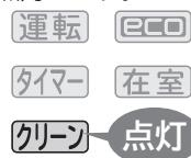
●動作確認開始後に「クリーン」ランプが点滅(4秒点灯/1秒消灯)表示したときはフィルター掃除ユニットが、異常で停止しています。
