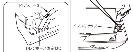
ドレンキャップは固定ねじを外して、抜きます。
