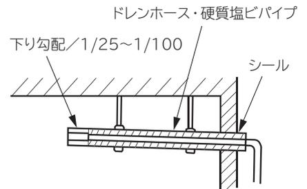
気密性の高い住宅などで強風時や換気扇を使用したときなどに、ドレン水がスムーズに流れず、異音(ポコポコ音等)が発生したり、水漏れが発生することがあります。
