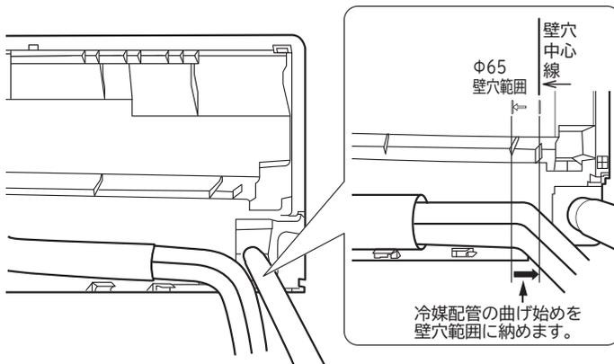
冷媒配管の曲げ始めが壁穴範囲から出ていると、曲げRが大きくと、室内機が壁から浮き上がり、仕上がりが悪くなる原因となります。
