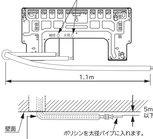
できるだけ小さなRで曲げてください（ポリシンを使用すると配管を潰さずに小さなRで曲げることができます）。
