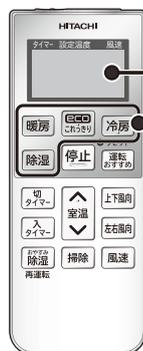
運転停止状態で、約3分間操作しないと節電のため液晶表示を消灯します。ボタンを押すと再表示します。
