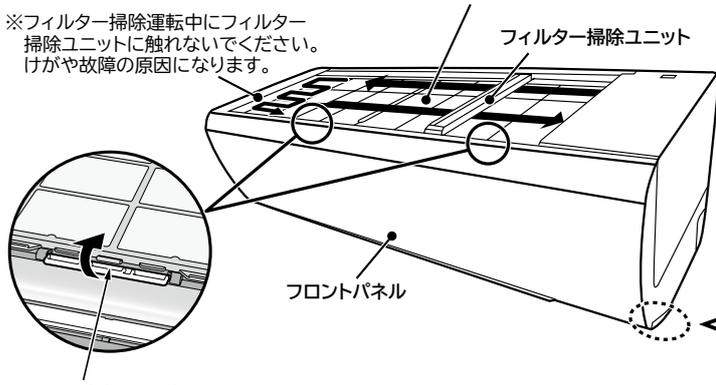
※エアフィルターが確実に取付けられて、エアフィルターロックがロックされていることを確認してください。ロックしていないと、運転中にエアフィルターが外れることがあります。
