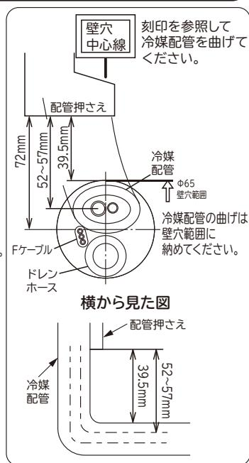
冷媒配管の曲げ始めが壁穴範囲から出でていたり、曲げRが大きいと、室内機が壁から浮き上がり、仕上りが悪くなる原因となります。
